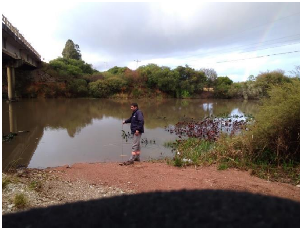
Figura 4 – Coleta de amostra para análise de sólidos em suspensão com o amostrador DH-48. Fonte: Ecossis, 2021.
