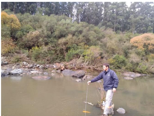
Figura 7 - Coleta de amostra para análise de sólidos em suspensão com o amostrador DH-48. Fonte: Ecossis, 2021.
